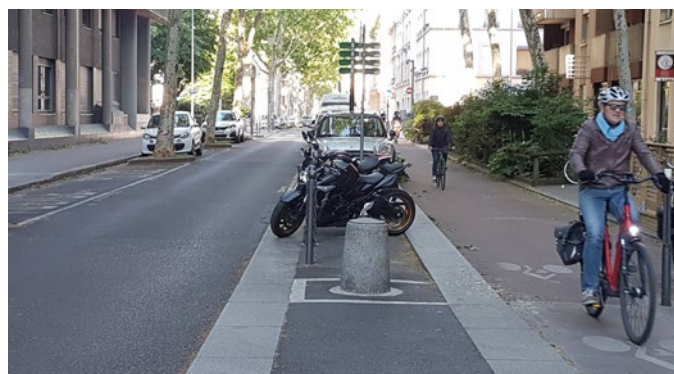
Rue en zone 30, à sens unique pour les véhicules motorisés. Le choix a été fait de mettre un axe structurant pour les déplacements des cyclistes dans cette rue avec une piste bidirectionnelle.
