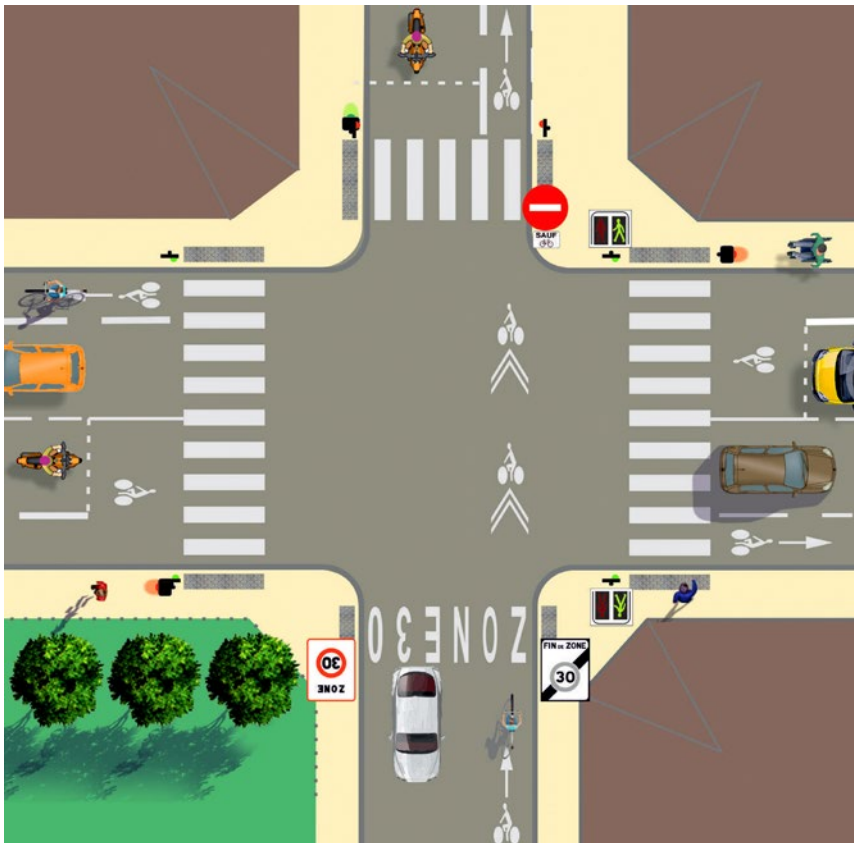
Sens réservé aux cyclistes, trajectoire contiguë au passage piéton en sortie de double-sens cyclable d'une zone 30
